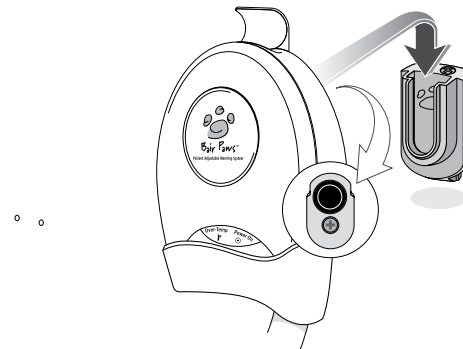
Abbildung 6. Befestigung des Erwärmungssystems mit einem Einlassadapter für die Wandmontage
